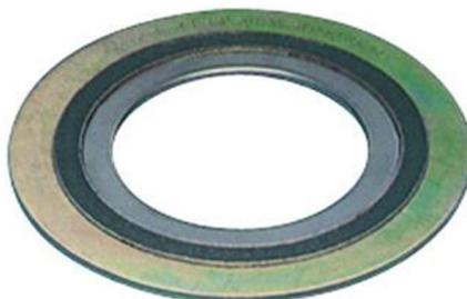
La guarnizioni spirometalliche vengono utilizzate in sostituzione alle guarnizioni plastiche (Esente amianto o grafite) quando vengono superati i loro limiti di applicazione. Vengono realizzate alternando giri di nastro metallico, preformato a V, e di riempitivo inorganico (Filler), possono essere realizzate su specifiche standard (ASME, API, UNI EN) o disegno del cliente.
